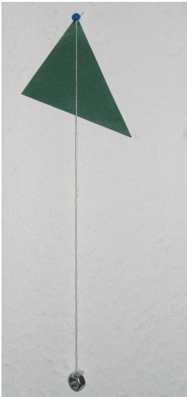
Befestigt nun an einem Faden die Schraubenmutter, dies nennt man eine Lotschnur!
